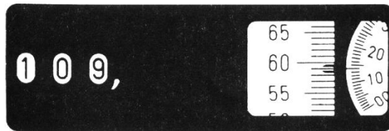
Fig. 3.4.- Dispositivo auxiliar de indicación
