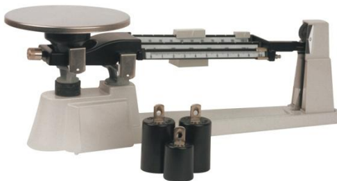
Fig. 3.2.- Instrumento de Pesar de funcionamiento No Automático
